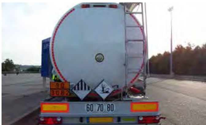
Citerne routière transportant une matière dangereuse du point de vue de l'environnement
