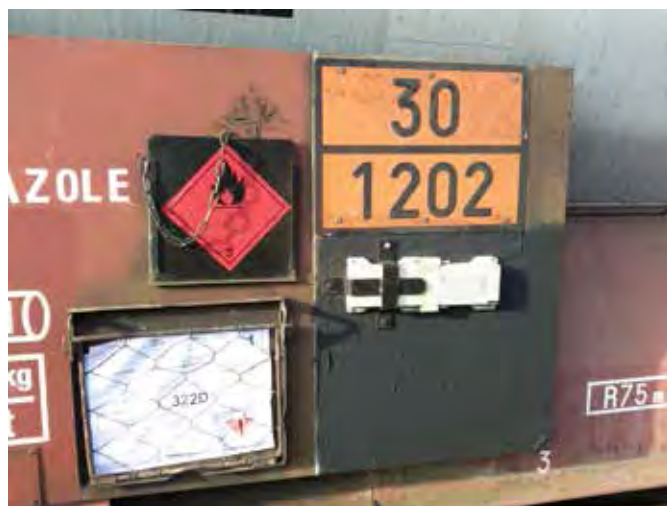
Signalisation et placardage d'un wagon-citerne contenant du gazole
