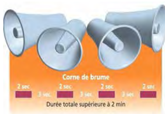
Signal d'alerte spécifique aux ouvrages hydrauliques
